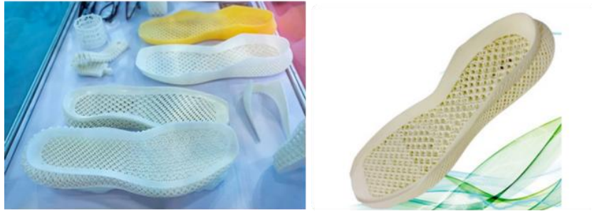
Görsel 2. Eklemeli imalat (3B baskı) ile üretilmiş kafes yapılı esnek taban modülleri. (Sol görsel Vialva'dan (2019), sağ görsel ise Doral Health & Wellness'tan (2025) alınmıştır.).
